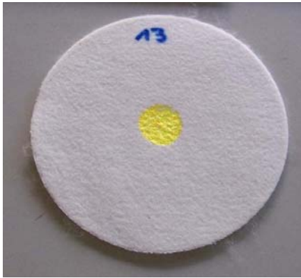
PROBE 13 langsame Druckerhöhung bis 2,3 bar,
